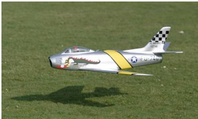
Die F-86 ist ein Voll-GFK Elektro-Impeller Modell für Impeller mit 70 – 90mm (maximaler Mantelaussendurchmesser 94mm). Rumpf und Tragfläche sind in einem Stück laminiert. Das Modell ist im Massstab 1:10 gehalten.
