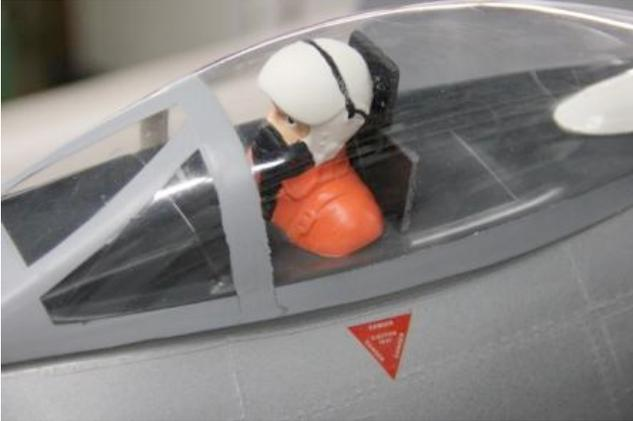
Die Cockpitwanne kann nach eigenem Ermessen ausgebaut werden. Die Verglasung und mit der Wanne verkleben.
