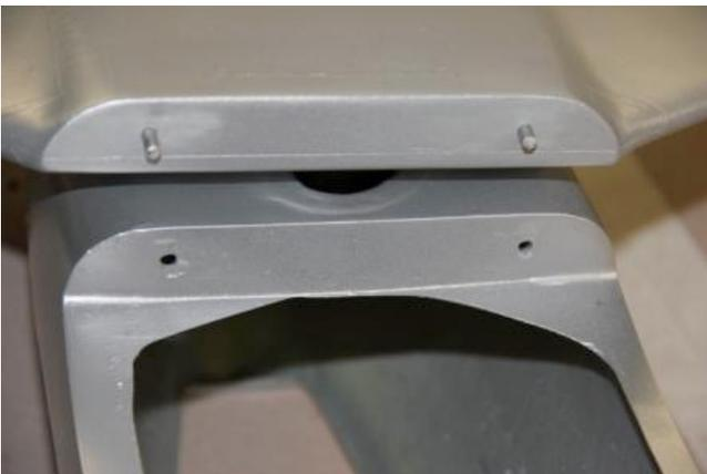
Für die vordere Flächenbefestigung werden an den markierten Stellen 2 Dübel (  $\varnothing$  6 mm ) festgeklebt. Rumpfseitig sind die Löcher passend auszuarbeiten.
