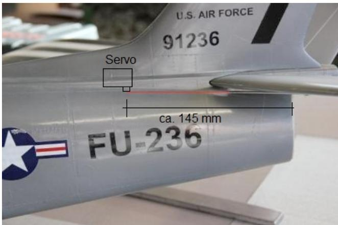
Als Höhensteuerservo kommen 2 Stück 9 – 11mm Servo zum Einsatz. Wir haben Graupner DES 488 verwendet. Die Servos auf Nullposition bringen und die Kabel verlängern. Die Höhe provisorisch montieren, das Gestänge durch die Öffnung schieben und in die Servohebel einhängen. Nun kann durch verschieben der Servos die Lage der Ruderhörner bestimmt werden. Mit einem Blick durch den Auslass prüfen ob die Servos nicht in den Schubkanal ragen.
