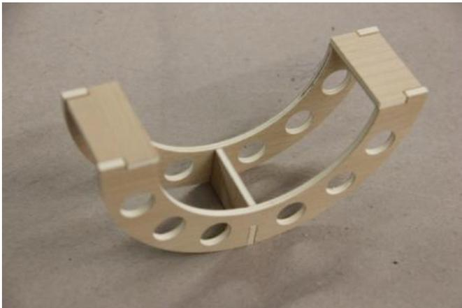
Der Impellerspant wird gemäss Foto zusammengesetzt und auf Passung kontrolliert.
