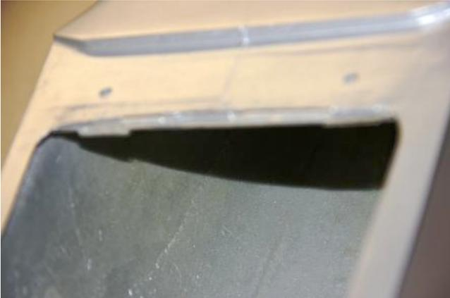
Zuerst wird ein Stück Pappelsperholz von innen an die hintere Flächenbefestigung geklebt. Die Stärke richtet sich nach den verwendeten Einschlagmuttern.
