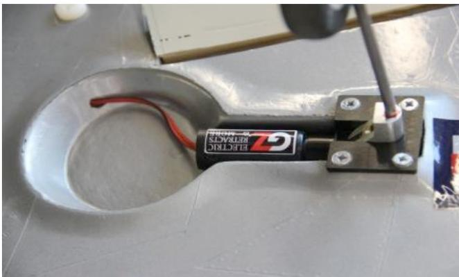
Nun die Hauptfahrwerkmechanik platzieren und festschrauben. Achtung: Bitte die Kabel oder Pressluftschlauch nicht in der Mitte der Fläche zum Rumpf führen. Da nimmt der Impeller schon den Platz weg und es bleiben nur wenige Millimeter. Führen sie die Kabel rechts und links in den Rumpf.
