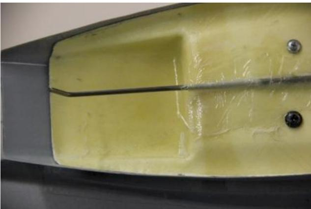
Hinten wird die Halterung mit einer Schraube und einem Schlitz in der Verglasung realisiert.
