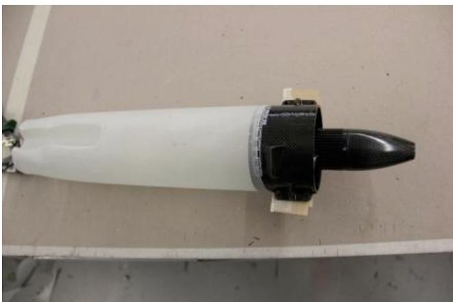
Die ganze Impellereinheit, hier im Bild ausserhalb des Modells, wird in den Rumpf eingeschoben und mit Klebeband gesichert. Nun kann der Spant passgenau mit den Laschen des Impellers verklebt werden.
